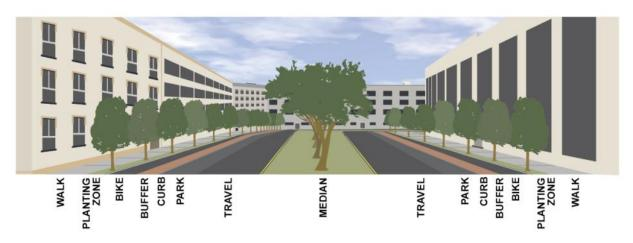
FIGURE 6-2 POTENTIAL ELEMENTS OF THE TYPICAL STREET RIGHT-OF-WAY
