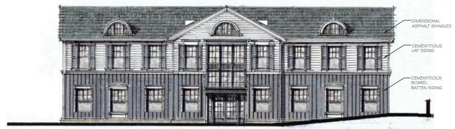
3 WEST ELEVATION SCALE: 1/8" = 1'-0"
