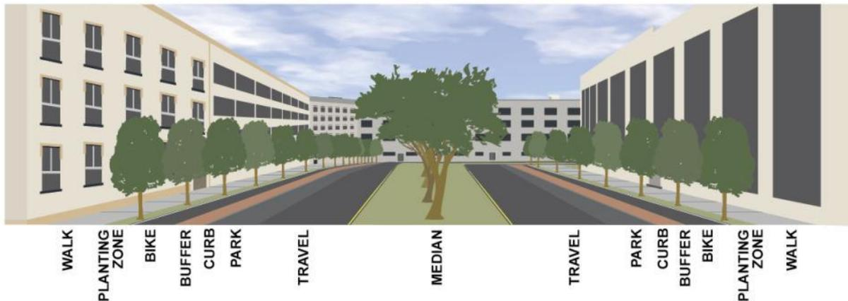
**FIGURE 6-2 POTENTIAL ELEMENTS OF THE TYPICAL STREET RIGHT-OF-WAY**
